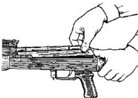
Рис. 13. Отделение крышки ствольной коробки
