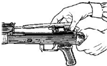
Рис. 15. Отделение затворной рамы с затвором
