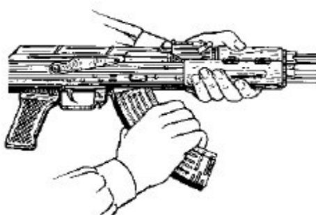
Рис. 19. Присоединение газовой трубки
